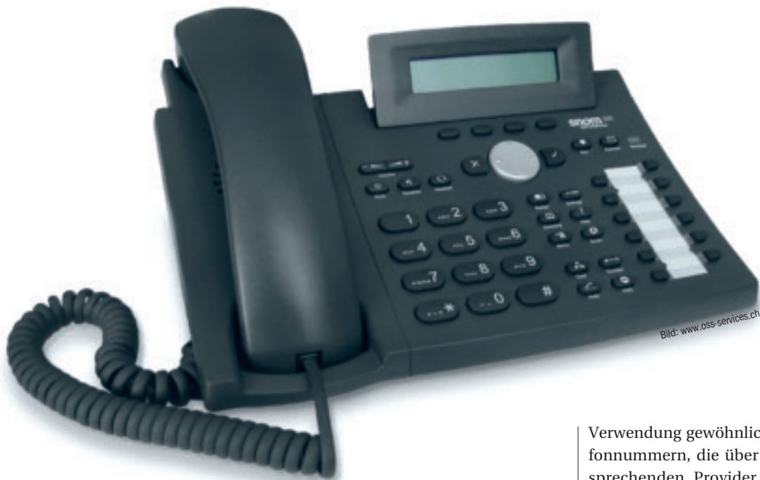
Beispiel: SIP-Business-Internet-Telefon «snom 320» mit minimierter Sprachverzögerung, Freisprech- und Konferenzfunktion. Angeschlossen wird es an bestehende IT-Netzwerke.
