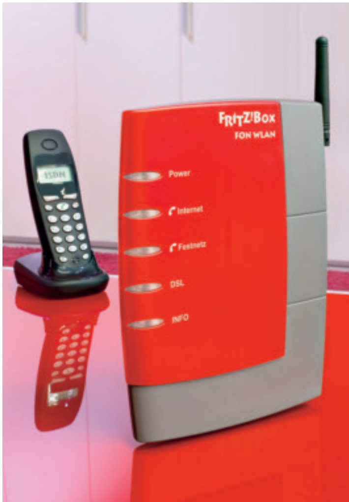
Beispiel: VoIP-Adapter «Fritz Box Fon WLAN 7050». Über einen solchen können bereits vorhandene ISDN-Telefone, ISDN-Anlagen und Analog-Telefone für Internet-Telefonie am DSL-Anschluss eingesetzt werden.
